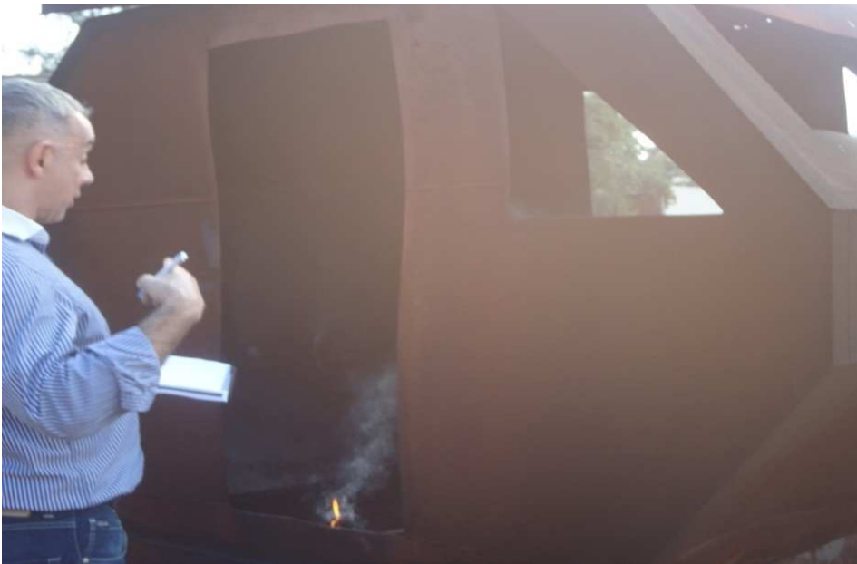
Foto 12: Ilustra verificação da contenção do fogo logo após o lançamento da granada e refrigeração no local em chamas.
