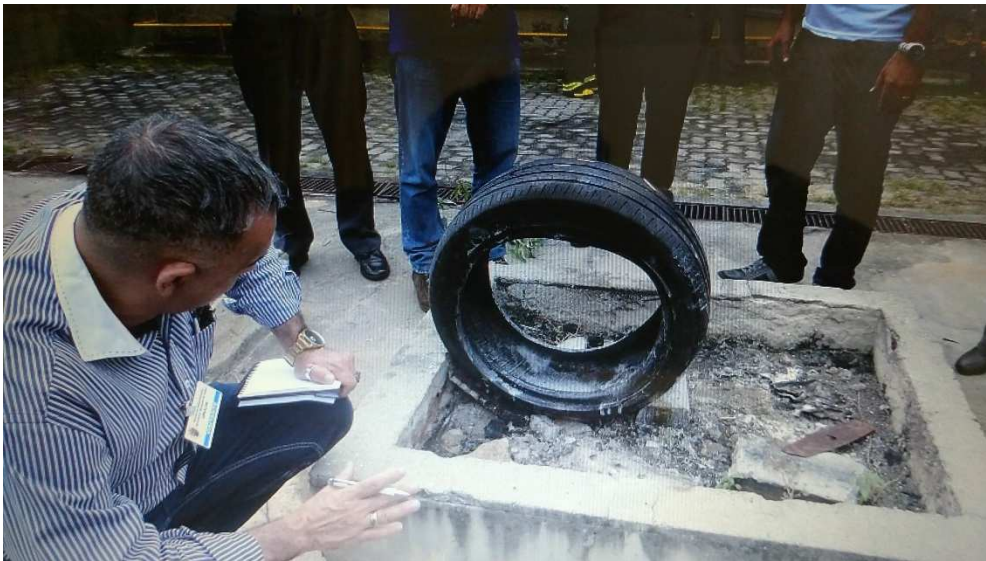
Foto 05: Ilustra a constatação de eliminação do fogo e resfriamento da temperatura na área incandescente do pneu.
