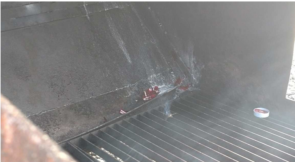
Foto 08 : Ilustra a ampola rompida após o aquecimento da mesma e eliminação do fogo.
