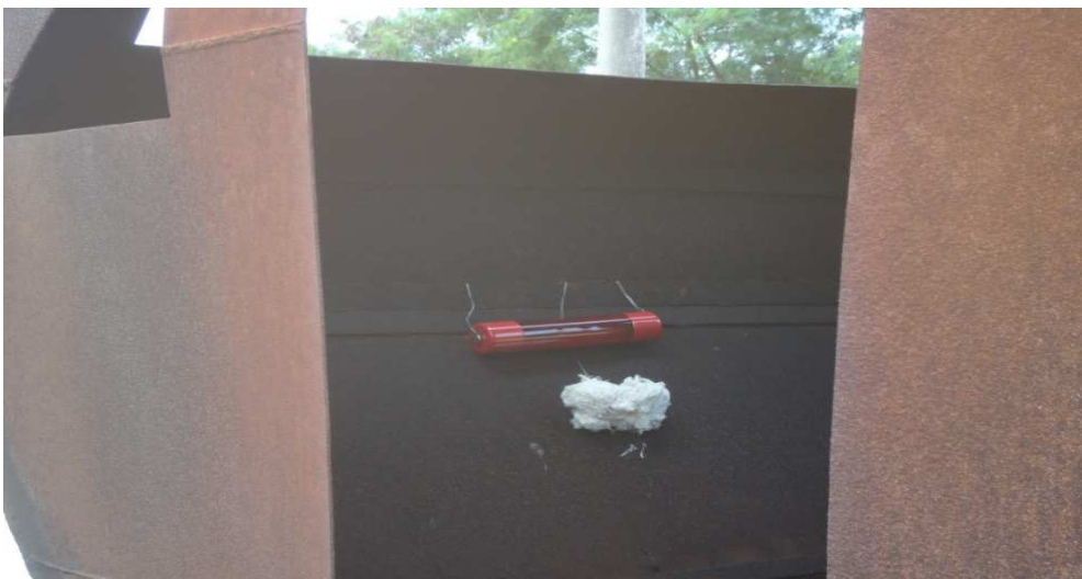
Foto 06: Ilustra o posicionamento da ampola e estopa embebida de líquido inflamável querosene
