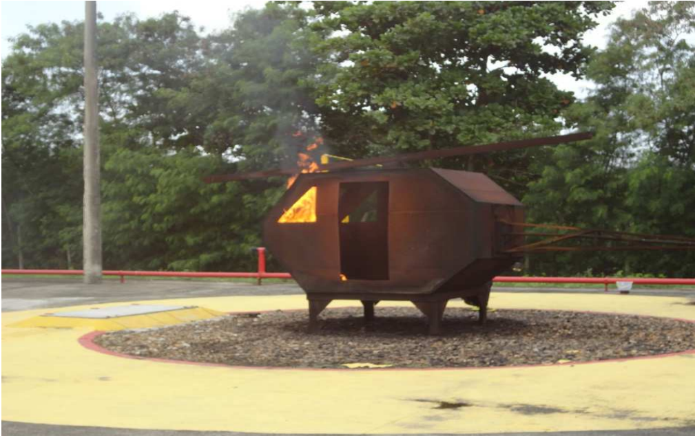
Foto 07: Ilustra o local da ampola sobre ação de fogo induzido no corpo de prova helicóptero.
