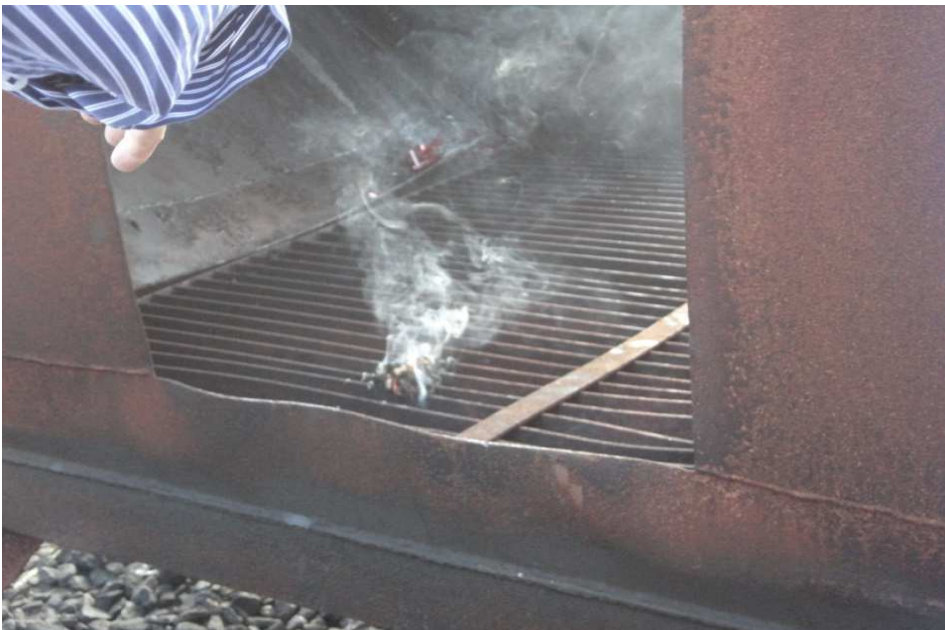
Foto 13: Ilustra a contenção total do fogo pelo uso da granada.
